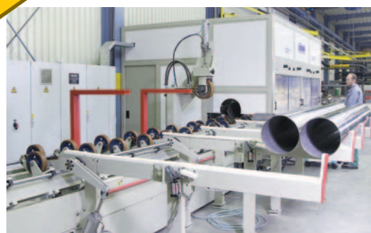
Oberflächenschleifen der Walzen Surface grinding of rollers
