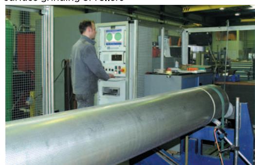
Auswuchten der Walzen Balancing of rollers
