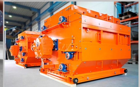
Zellenradschleuse für Dosieranlage
